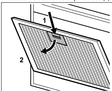
2. Kallista suodattimen etuosaa hiukan alaspäin
