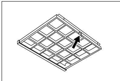
**3.** Při instalaci nového filtru provedte stejný postup v opačném pořadí.
